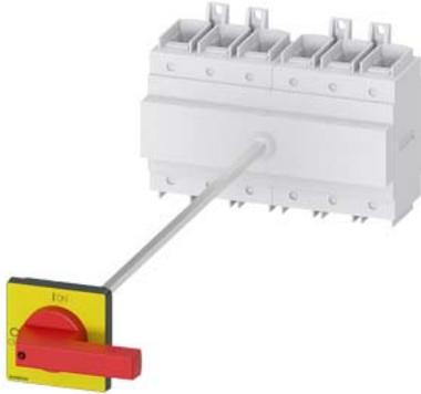
SETRON, sezionatore sottocarico 3LD, interruttore di arresto di emergenza, 6-poli, Iu: 160 A, potenza di impiego / per AC-23 A con 400 V: 75 kW, fissaggio su base con bloccoporta, comando a leva, rosso/giallo fissaggio a 4 fori dell'operatore
