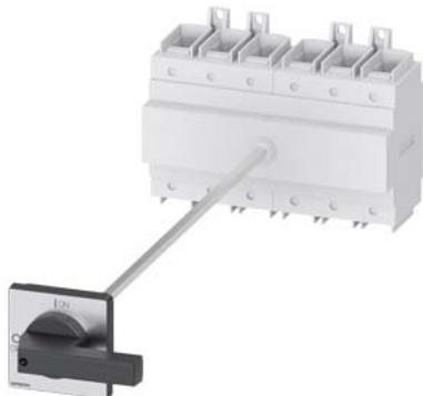
SENTRON, sezionatore sottocarico 3LD, interruttore principale, a 6 poli, Iu: 160 A, potenza in esercizio / per AC-23 A / con 400 V: 75 kW, fissaggio su base con bloccoporta, comando a leva, nero, fissaggio a 4 fori dell'operatore
