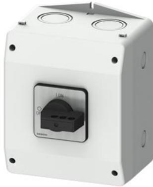
sezionatore sottocarico SENTRON 3LD nella custodia, interruttori per manutenzione e riparazione con lamierino di schermatura EMC, a 6 poli, Iu: 32A, AC 23 A 400 V a 50/60 Hz: 11,5 kW per funzionamento con convertitore: AC20 400V da 0 a 550 Hz: 7,5 kW, 1NO + 1NC anticipato di 20 ... 150ms, custodia in materiale isolante per raccordo a vite metrico, comando a leva, nero, bloccabile in posizione 0 e I, incl. mollette per lo schermo
