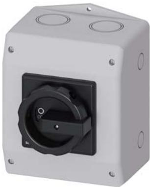
SENTRON, sezionatore sottocarico 3LD, interruttore principale, a 6 poli, Iu: 32 A, potenza in esercizio / per AC-23 A / con 400 V: 11,5 kW, custodia in materiale isolante per raccordo a vite metrico, comando rotativo, nero
