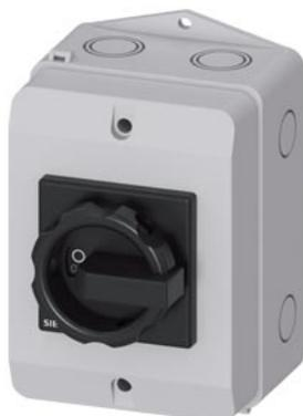
SETRON, sezionatore sottocarico 3LD, interruttore principale, a 4 poli, 32 A, potenza di impiego con AC 23 A con 400 V: 11,5 kW, custodia in materiale isolante per raccordo a vite metrico, comando rotativo, nero
