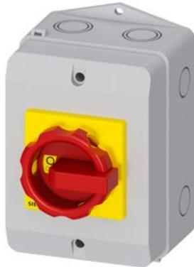
SETRON, sezionatore sottocarico 3LD, interruttore di arresto di emergenza, 3-poli, Iu: 32 A, potenza di impiego / per AC-23 A con 400 V: 11,5 kW, custodia in materiale isolante per raccordo a vite metrico, comando rotativo, rosso/giallo
