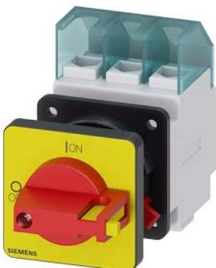
SENTRON, sezionatore sottocarico 3LD, interruttore di arresto di emergenza, 3-poli, Iu: 32 A, potenza di impiego / per AC-23 A con 400 V: 11,5 kW, fissato frontalmente, comando a leva, rosso/giallo fissaggio centrale 22,5 mm dell'operatore
