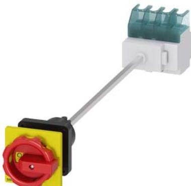
SETRON, sezionatore sottocarico 3LD, interruttore di arresto di emergenza, 4-poli, I<sub>n</sub>: 32 A, potenza di impiego / per AC-23 A con 400 V: 11,5 kW, fissaggio su base con bloccoporta, comando rotativo, rosso/giallo fissaggio centrale 22,5 mm dell'operatore
