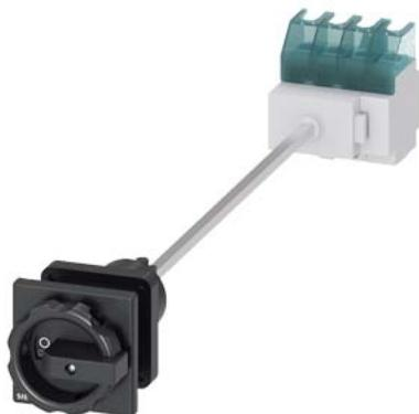
SENTRON, sezionatore sottocarico 3LD, interruttore principale, a 4 poli, Iu: 32 A, potenza in esercizio / per AC-23 A / con 400 V: 11,5 kW, fissaggio su base con bloccoporta, comando rotativo, nero, fissaggio centrale 22,5 mm dell'operatore
