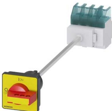
SETRON, sezionatore sottocarico 3LD, interruttore di arresto di emergenza, a 4 poli, Iu: 32 A, potenza in esercizio / per AC-23 A / con 400 V: 11,5 kW, fissaggio su base con bloccoporta, comando a leva comando a leva, rosso/giallo fissaggio a 4 fori dell'operatore
