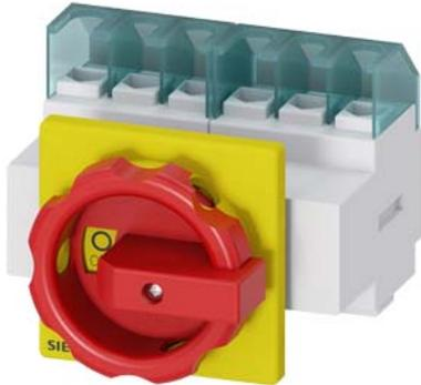
SETRON, sezionatore sottocarico 3LD, interruttore di arresto di emergenza, 6-poli, I<sub>n</sub>: 32 A, potenza di impiego / per AC-23 A con 400 V: 11,5 kW, fissato frontalmente, comando rotativo, rosso/giallo fissaggio a 4 fori dell'operatore
