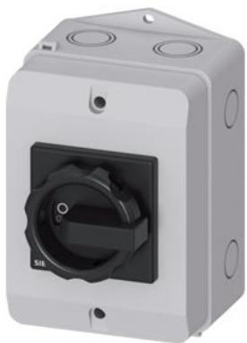
SENTRON, sezionatore sottocarico 3LD, interruttore principale, a 4 poli, 25 A, potenza di impiego con AC 23 A con 400 V: 9,5 kW, custodia in materiale isolante per raccordo a vite metrico, comando rotativo, nero
