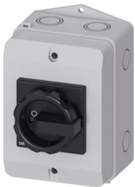
SENTRON, sezionatore sottocarico 3LD, interruttore principale, a 3 poli, Iu: 25 A, potenza in esercizio / per AC-23 A / con 400 V: 9,5 kW, custodia in materiale isolante per raccordo a vite in pollici, comando rotativo, nero
