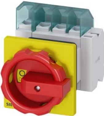
SENTRON, sezionatore sottocarico 3LD, interruttore di arresto di emergenza, 4-pol, Iu: 25 A, potenza di impiego / per AC-23 A con 400 V: 9,5 kW, fissato frontalmente, 1 NC, 1 NO, comando rotativo, rosso/giallo fissaggio centrale 22,5 mm operatore
