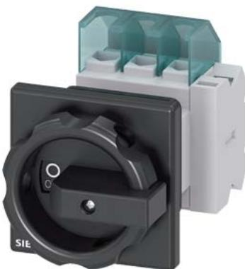
SENTRON, sezionatore sottocarico 3LD, interruttore principale, a 3 poli, Iu: 25 A, potenza in esercizio / per AC-23 A / con 400 V: 9,5 kW, fissato frontalmente, 1 NC, 1 NO, comando rotativo, nero, fissaggio centrale 22,5 mm operatore
