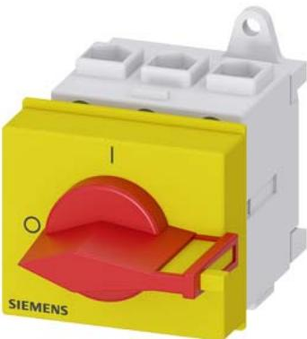
SENTRON, sezionatore sottocarico 3LD, interruttore di arresto di emergenza, 3-poli, I<sub>u</sub>: 25 A, potenza di impiego / per AC-23 A con 400 V: 9,5 kW, montaggio nel quadro di distribuzione, comando a leva, rosso/giallo operatore direttamente sull'interruttore
