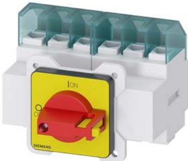
SENTRON, sezionatore sottocarico 3LD, interruttore di arresto di emergenza, a 6 poli, I<sub>lu</sub>: 25 A, potenza di impiego / per AC-23 A con 400 V: 9,5 kW, fissato frontalmente, comando a leva, rosso/giallo fissaggio a 4 fori dell'operatore, in posizione zero lucchettabile
