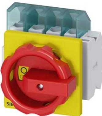
SENTRON, sezionatore sottocarico 3LD, interruttore di arresto di emergenza, 4-pol., Iu: 25 A, potenza di impiego / per AC-23 A con 400 V: 9,5 kW, fissato frontalmente, 1 NC, 1 NO, comando rotativo, rosso/giallo 4 fori dell'operatore
