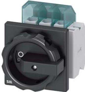
SETRON, sezionatore sottocarico 3LD, interruttore principale, a 3 poli, Iu: 25 A, potenza in esercizio / per AC-23 A / con 400 V: 9,5 kW, fissato frontalmente, 1 NC, 1 NO, comando rotativo, nero, 4 fori dell'operatore
