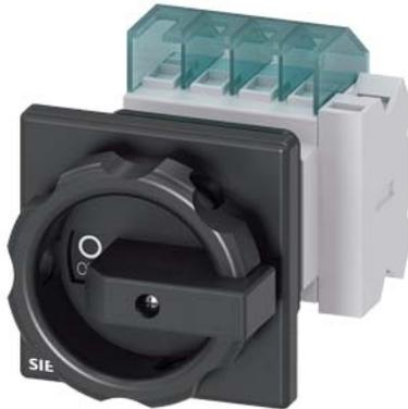
SETRON, sezionatore sottocarico 3LD, interruttore principale, a 3 poli, Iu: 16 A, potenza in esercizio / per AC-23 A / con 400 V: 7,5 kW, fissato frontalmente, 1 NC, 1 NO, comando rotativo, nero, fissaggio centrale 22,5 mm operatore
