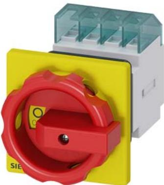
SENTRON, sezionatore sottocarico 3LD, interruttore di arresto di emergenza, 4-pol, Iu: 16 A, potenza di impiego / per AC-23 A con 400 V: 7,5 kW, fissato frontalmente, comando rotativo, rosso/giallo fissaggio centrale 22,5 mm dell'operatore
