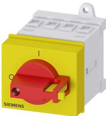
SENTRON, sezionatore sottocarico 3LD, interruttore di arresto di emergenza, 3-pol, Iu: 16 A, potenza di impiego / per AC-23 A con 400 V: 7,5 kW, montaggio nel quadro di distribuzione, comando a leva, rosso/giallo operatore direttamente sull'interruttore
