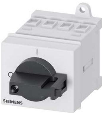
SENTRON, sezionatore sottocarico 3LD, interruttore principale, a 3 poli, I<sub>u</sub>: 16 A, potenza in esercizio / per AC-23 A / con 400 V: 7,5 kW, montaggio nel quadro di distribuzione, comando a leva, nero, operatore direttamente sull'interruttore
