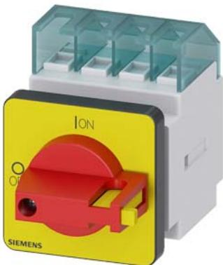
SENTRON, sezionatore sottocarico 3LD, interruttore di arresto di emergenza, 4-pol, Iu: 16 A, potenza di impiego / per AC-23 A con 400 V: 7,5 kW, fissato frontalmente, comando a leva, rosso/giallo fissaggio a 4 fori dell'operatore
