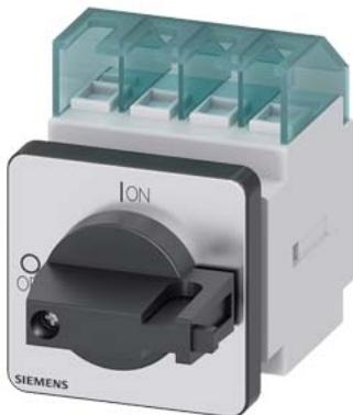
SENTRON, sezionatore sottocarico 3LD, interruttore principale, a 4 poli, Iu: 16 A, potenza in esercizio / per AC-23 A / con 400 V: 7,5 kW, fissato frontalmente, comando a leva, nero, fissaggio a 4 fori dell'operatore
