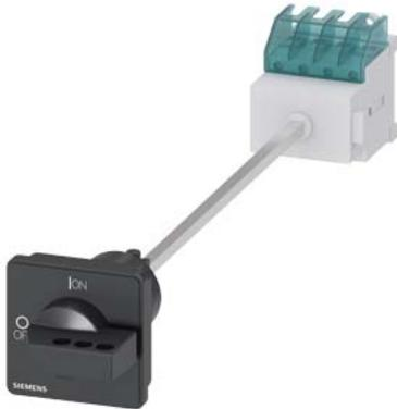
SETRON, sezionatore sottocarico 3LD, interruttore principale, a 3 poli, Iu: 16 A, potenza in esercizio / per AC-23 A / con 400 V: 7,5 kW, fissaggio su base con bloccoporta, comando a leva aggirabile, nero, fissaggio a 4 fori dell'operatore
