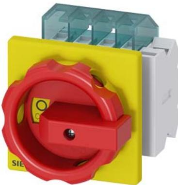
SENTRON, sezionatore sottocarico 3LD, interruttore di arresto di emergenza, 3-pol, Iu: 16 A, potenza di impiego / per AC-23 A con 400 V: 7,5 kW, fissato frontalmente, 1 NC, 1 NO, comando rotativo, rosso/giallo 4 fori dell'operatore
