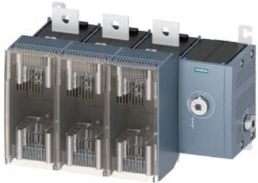
Sezionatore sottocarico con fusibile 800A, grand. costr. 5, a 3 poli per fusibile NH gr. 2 e 3 comando parete laterale a destra apparecchio di base senza maniglia attacco piatto
