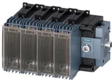
Sezionatore sottocarico con fusibile 32A, grand. costr. 1, a 4 poli per fusibile NH gr. 000 comando parete laterale a destra apparecchio di base senza maniglia morsetto serracavo
