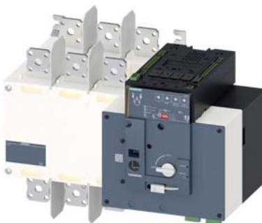
SENTRON, ATE, commutatore di rete 3KC, automatico, ATSE, 3- poli, Iu: 1000 A, Ue AC: 415 V, le con AC-33 B con 415V: 800 A, le con AC-23 A con 690V: 630 A, fissaggio a vite, comando a motore, sull'estremità destra, manopola con leva di comando lunga attacco a sbarra
