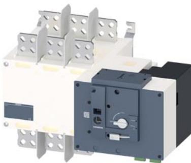
SENTRON, commutatore di rete 3KC, con comando a distanza, RTSE, a 3 poli, Iu: 1250 A, Ue AC: 415 V, Ie AC-33 B a 415V: 1000 A, Ie con AC-23 A con 690V: 800 A, fissaggio a vite, comando a motore, sull'estremità destra, manopola con leva di comando lunga attacco a sbarra
