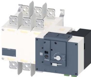
SENTRON, commutatore di rete 3KC, con comando a distanza, RTSE, a 3 poli, I<sub>u</sub>: 800 A, Ue AC: 415 V, le a AC-33 B a 415V: 800 A, le con AC-23 A con 690V: 630 A, fissaggio a vite, comando a motore, sull'estremità destra, manopola con leva di comando lunga attacco a sbarra
