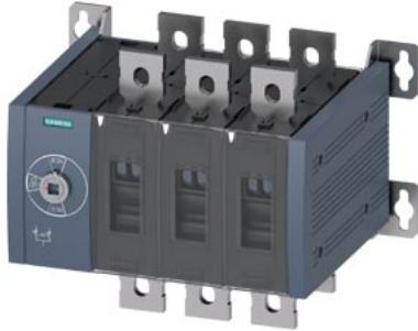
SENTRON, commutatore di rete 3KC, con comando manuale, MTSE, grandezza costruttiva: 4, a 3 poli, lu: 630 A, Ue AC: 415 V, le con AC-33 B con 415V: 500 A, le con AC-23 A a 690 V: 500 A, fissaggio a vite, comando frontale, sull'estremità sinistra, senza maniglia, attacco a sbarra
