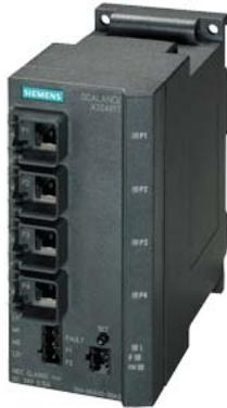
SCALANCE X204IRT, managed IE IRT Switch, 4x 10/100 Mbit/s RJ45, contatto di segnalazione errore con tasto SET, ridondanza della alimentazione di tensione, PROFINET IO Device, Network Management, manager di ridondanza integrato, incl. manuale elettronico su CD-ROM, C-PLUG opzionale.
