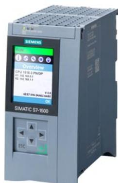
SIMATIC S7-1500, CPU 1516-3 PN/DP, unità centrale con memoria di lavoro 1 Mbyte per programma e 5 Mbyte per dati, 1<sup>a</sup> interfaccia: PROFINET IRT con switch a 2 porte, 2<sup>a</sup> interfaccia: PROFINET RT, 3<sup>a</sup> interfaccia: PROFIBUS, performance a bit di 10 ns, SIMATIC Memory Card necessaria
