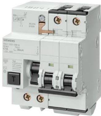
Interruttore magnetotermico differenziale, 4,5 kA, 2 P, Tipo AC, 30 mA, Car. C, In: 10 A, Un AC: 400 V, linea residenziale ,
