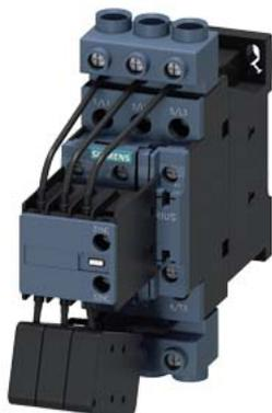
contattore per condensatore, AC-6b 33 kVAr, / 400 V 1 NO + 2 NC, AC 400 V, 50 Hz a 3 poli, grandezza costruttiva S0 morsetto a vite
