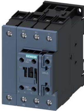
contattore di potenza, AC-3 40 A, 18,5 kW / 400 V 2 NO + 2 NC DC 48-80 V a 4 poli grandezza costruttiva S2 morsetti a vite 1 NO + 1 NC integrati
