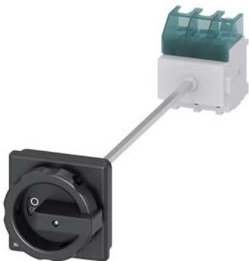
SENTRON, sezionatore sottocarico 3LD, interruttore principale, a 3 poli, Iu: 63 A, potenza in esercizio / per AC-23 A / con 400 V: 22 kW, fissaggio su base con bloccoporta, comando rotativo, nero, fissaggio a 4 fori dell'operatore, senza compensazione della tolleranza
