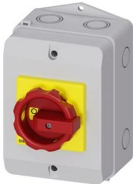
SENTRON, sezionatore sottocarico 3LD, interruttore di arresto di emergenza, 4- poli, 25 A, potenza di impiego nominale per AC-23 A / con 400 V: 9,5 kW, custodia in materiale isolante per raccordo a vite metrico, comando rotativo, rosso/giallo
