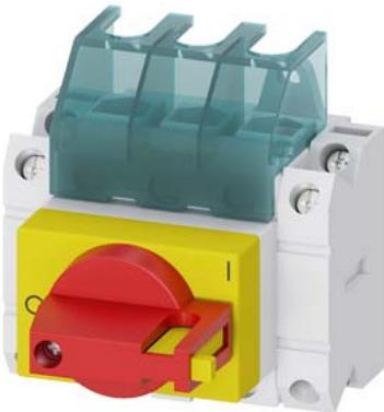
SENTRON, sezionatore sottocarico 3LD, interruttore di arresto di emergenza, 3- poli, Iu: 25 A, potenza di impiego / per AC-23 A con 400 V: 9,5 kW, montaggio nel quadro di distribuzione, 3 NO, comando a leva, rosso/giallo operatore direttamente sull'interruttore
