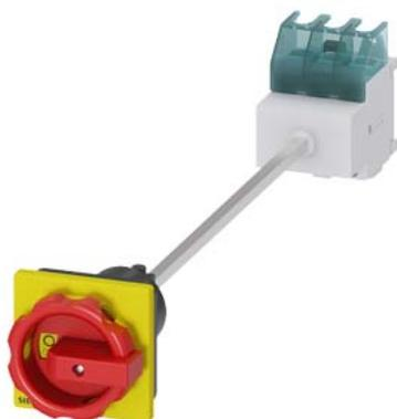
SENTRON, sezionatore sottocarico 3LD, interruttore di arresto di emergenza, 3- poli, lu: 25 A, potenza di impiego / per AC-23 A con 400 V: 9,5 kW, fissaggio su base con bloccoporta, comando rotativo, rosso/giallo fissaggio a 4 fori dell'operatore, senza compensazione della tolleranza
