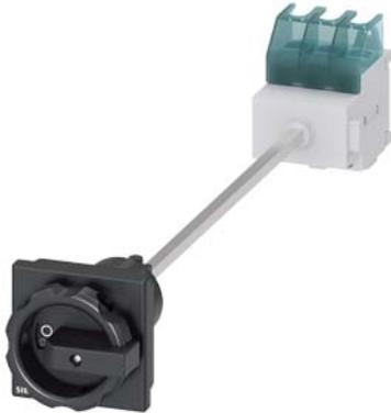
SETRON, sezionatore sottocarico 3LD, interruttore principale, a 3 poli, Iu: 25 A, potenza in esercizio / per AC-23 A / con 400 V: 9,5 kW, fissaggio su base con bloccoporta, comando rotativo, nero, fissaggio a 4 fori dell'operatore, senza compensazione della tolleranza
