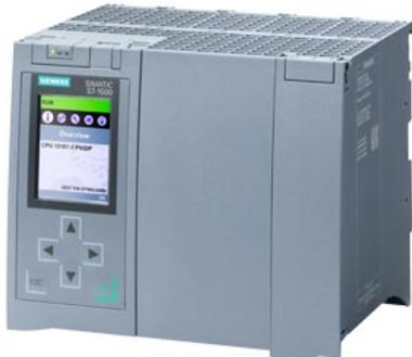
SIMATIC S7-1500T, CPU 1516T-3 PN/DP, unità centrale con memoria di lavoro 1,5 MB per il programma e 5 MB per i dati, 1ª interfaccia: PROFINET IRT con 2 Port Switch, 2ª interfaccia, Ethernet, 3a interfaccia, PROFIBUS, performance a bit di 10 ns, SIMATIC Memory Card necessaria
