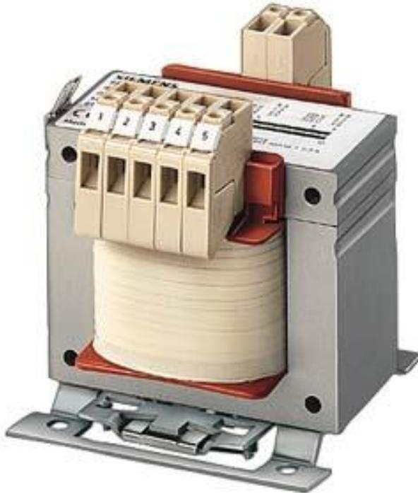
Trasformatore SITAS; fasi: 1; PN/PN (S6) (kVA): 0,16 /0,49; Upri (V): 440 ... 400 ... 230; Usec (V): 230 (2 x 115); Isec (A): 0,70 ... 1,39; F (Hz): 50 ... 60; gruppo di collegamento/avvolgimento di schermatura: IIII0 /0; classe TA/ISO: 40/B; IP00; collegamento: morsetti a vite/attacchi a spina piatta; collegamento; montaggio: viti / guida DIN; EN 61558-2-1, -2-2, -2-4 >UL/CSA-recognized< >Trasformatore di comando< >Trasformatore di isolamento<
