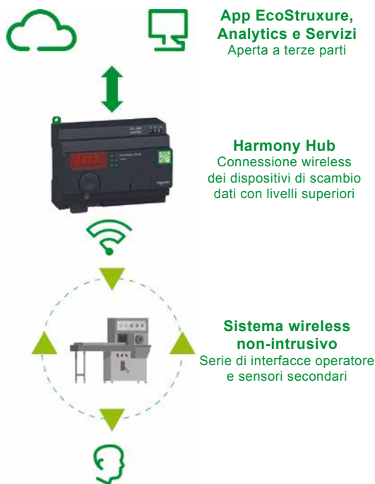
Schema di collegamento Harmony Hub
