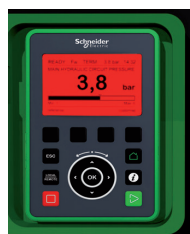
Erreur détectée : écran rouge en cas de détection d'erreur
