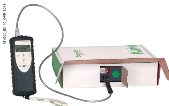
Configuration d'un variateur Altivar dans son emballage avec l'outil Multi-Loader VW3A8121
