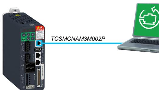
Configuration avec le logiciel de mise en service SoMove
