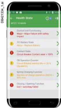
Le unità di controllo Micrologic X eseguono funzioni diagnostiche di alto livello in tempo reale sugli interruttori automatici Masterpact MTZ.
