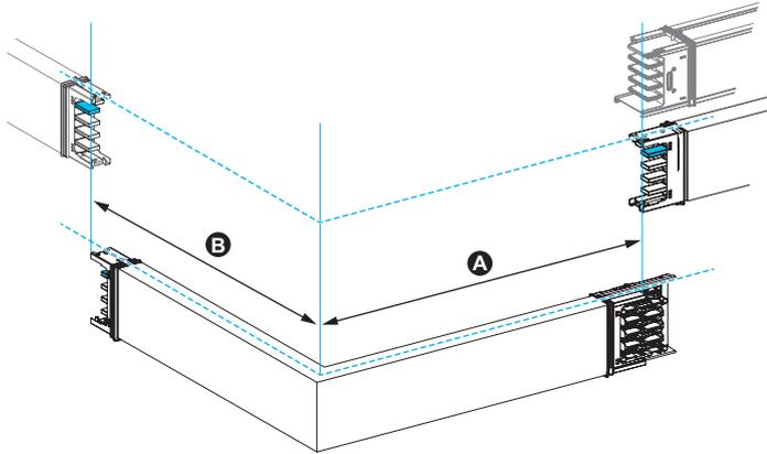
**A** = dimensione misurata dall'estremità inferiore dell'elemento di destra all'asse del lato **B**.
