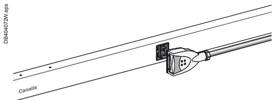
Nei condotti Canalis KBA e KBB le partenze dei connettori 16 A sono a gabbia. Come per tutti i connettori a vite è consigliabile verificare il serraggio un anno dopo l'installazione, effettuando poi controlli periodici regolari.
