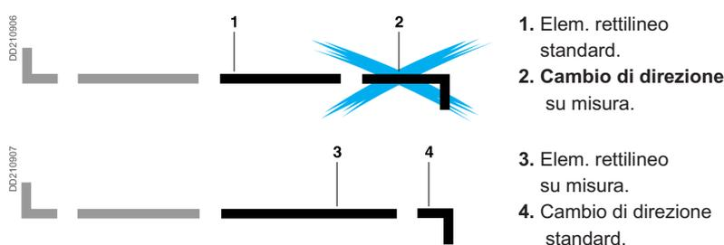
Sul progetto prevedere una quota minima di 700 mm per garantire sul posto una regolazione di  $\pm 200$  mm. La lunghezza minima degli elementi rettilinei è di 500 mm.
