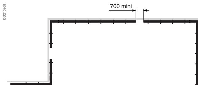
Per prevedere lo spazio necessario all'elemento di fine cantiere in attesa, installare i cambi di direzione (curve) e gli elementi corrispondenti in ogni angolo (sostenere l'insieme utilizzando due supporti su ciascun elemento rettilineo).
