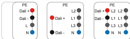
Il segnale DALI può essere veicolato anche utilizzando due dei conduttori normalmente utilizzati per il trasporto di potenza elettrica.
