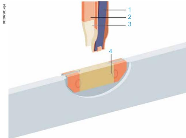
**In conclusione:** i contatti scorrevoli assorbono quindi la dilatazione dei conduttori a livello del blocco di giunzione o a livello delle prese di derivazione.
