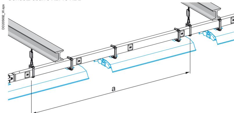
L'interasse di fissaggio dei condotti sbarre KBA e KBB è legato al numero e al peso dei corpi illuminanti oltre che al tipo di struttura dell'edificio. La tabella sottostante indica il carico ripartito massimo ammesso (kg) tra due elementi di fissaggio, per un valore di freccia 1/500e. In caso di carico concentrato al centro di due elementi di fissaggio (lampade fluorescenti), applicare a questi valori un coefficiente di 0.6.
