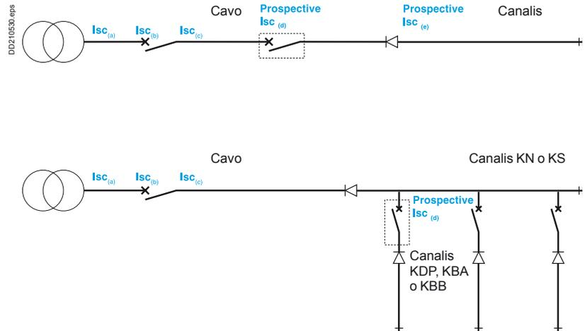
**Icc(a):** corrente di cortocircuito efficace ai morsetti del trasformatore.
