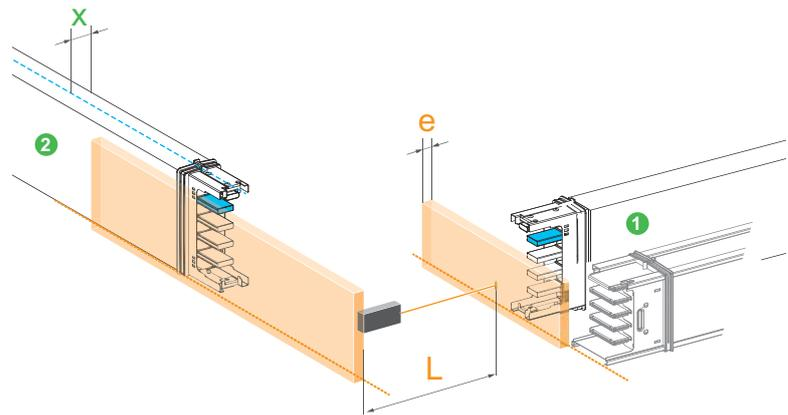
Calcolare **A** del cambio di direzione con la formula (mm):  $A = L + e - x$
