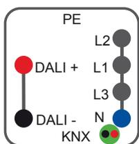
È possibile derivare potenza, segnale DALI e segnale KNX utilizzando una singola spina:
