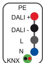
È possibile derivare potenza, segnale DALI e segnale KNX utilizzando una singola spina:
