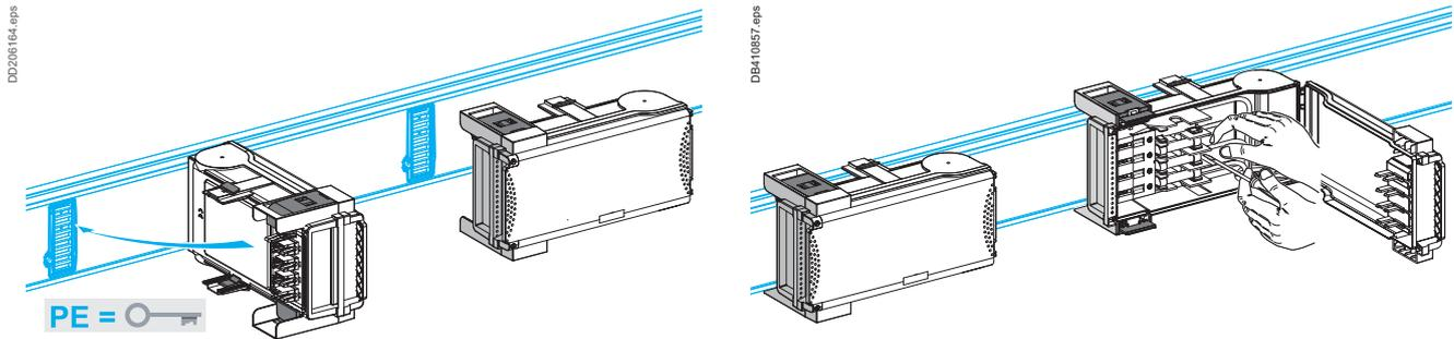
**Il grado di protezione è IP••B (impossibilità di accesso alle dita). Il grado di protezione standard è IP55 per installazione all'interno (senza bisogno di accessori).**
