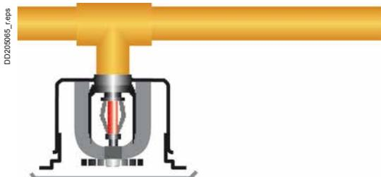
Lo sprinkler è un dispositivo antincendio automatico di estinzione “a pioggia”. Esso è progettato per rilasciare acqua quando la temperatura dell'ambiente circostante eccede il valore per cui l'elemento termosensibile (che funge in condizioni normali da tappo) è stato calibrato.
